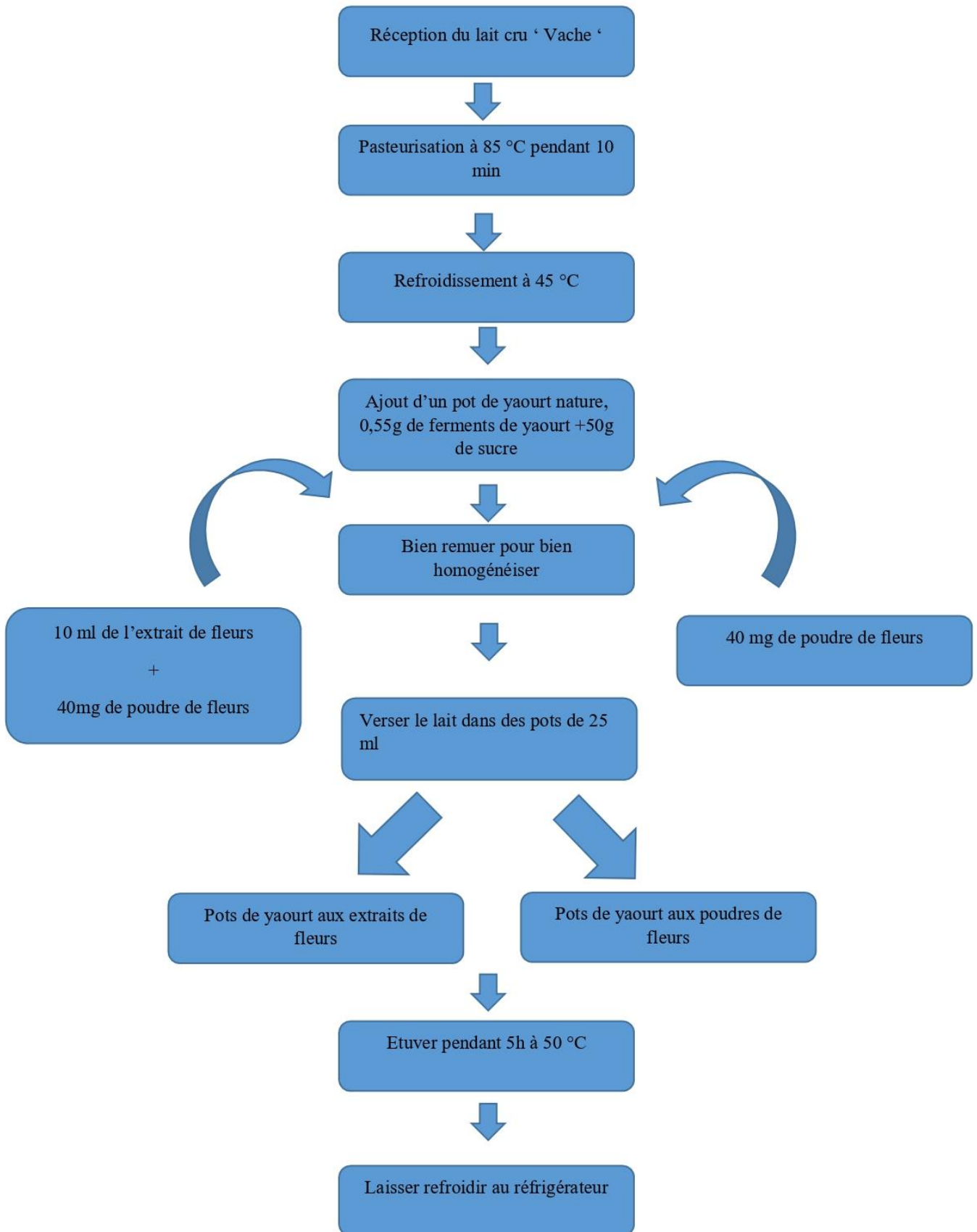
Figure 14 : Diagramme de fabrication d'un yaourt étuvé à base de poudre et extrait de fleurs comestibles (Anonyme 13)
