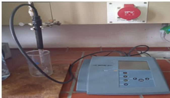
**Figure II.12** : Un conductimètre WTW Cond\_720
