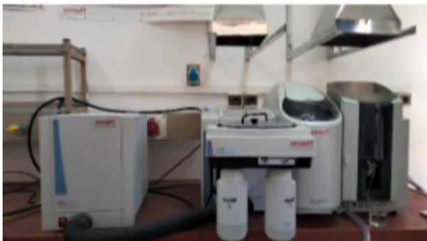
**Figure II.5.** : Le spectromètre d'absorption atomique (S.A.A) (thermo scientifique ; ICE 3000Series)
