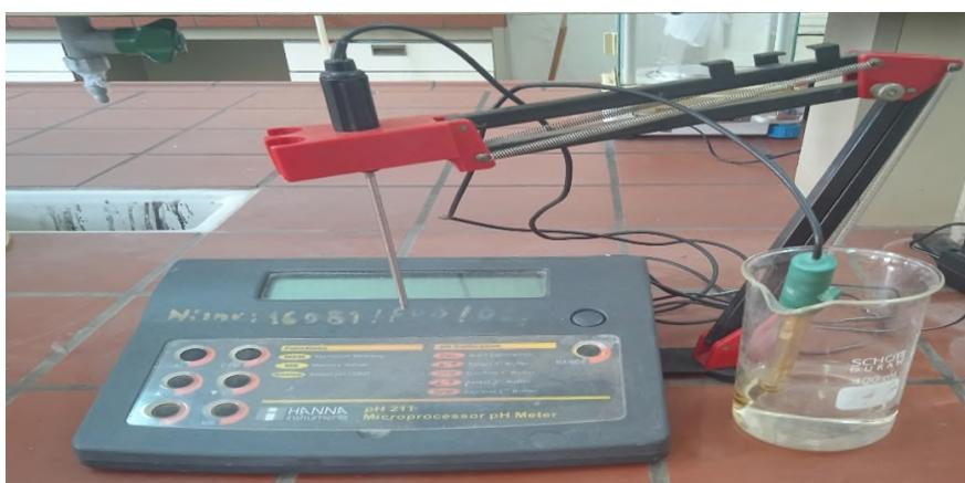
**Figure II.13** : Un pH mètre (pH 211 Micro processor pH mètre)
