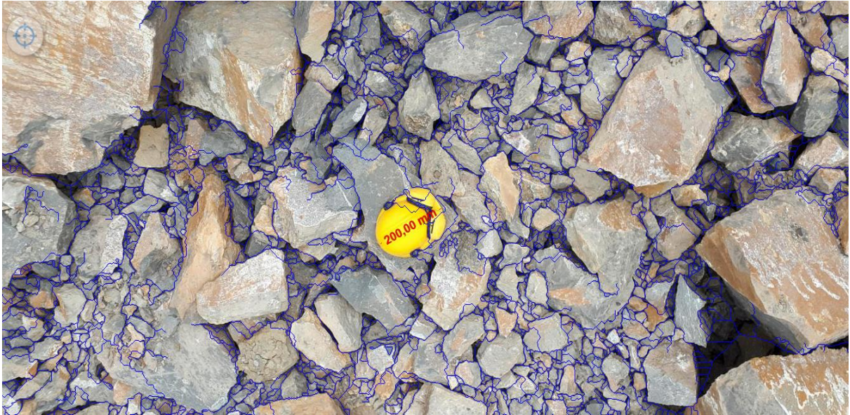
Figure III-13 : prise de photo avec un seul casque comme échelle de mesure
