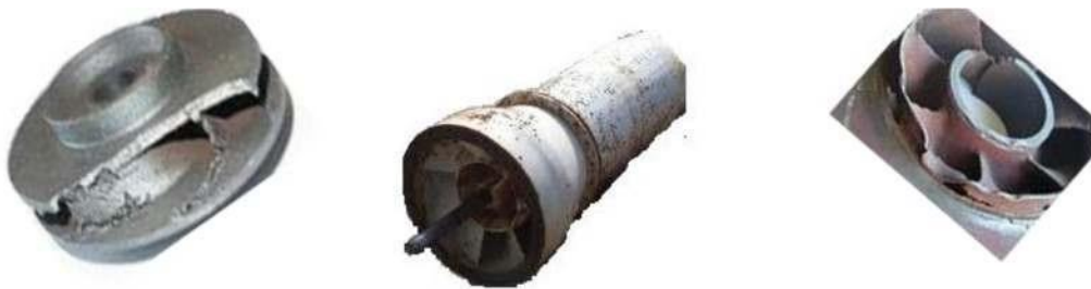
Figure I.29 : Dégâts de Cavitation sur les éléments d'une pompe centrifuge.
