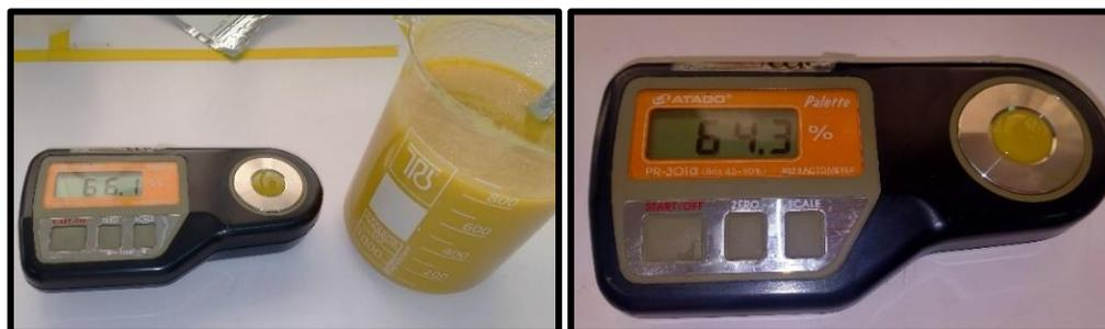
*Figure 13: photographie de mesure de taux de sucre à l'aide d'un réfractomètre*
