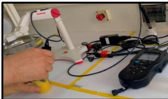
*Figure 12: Photographie de mesure de pH de pulpe d'orange*
