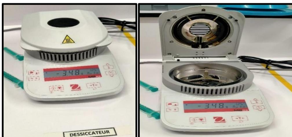
Figure 15: Photographie d'un dessiccateur
