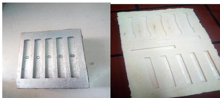
**Figure III .7** : moules normalisés utilisés pour fabriquer des éprouvettes pour les tests de traction et flexion.
