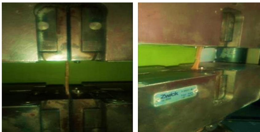
**Figure III.10 :** Procédés de test de traction.
