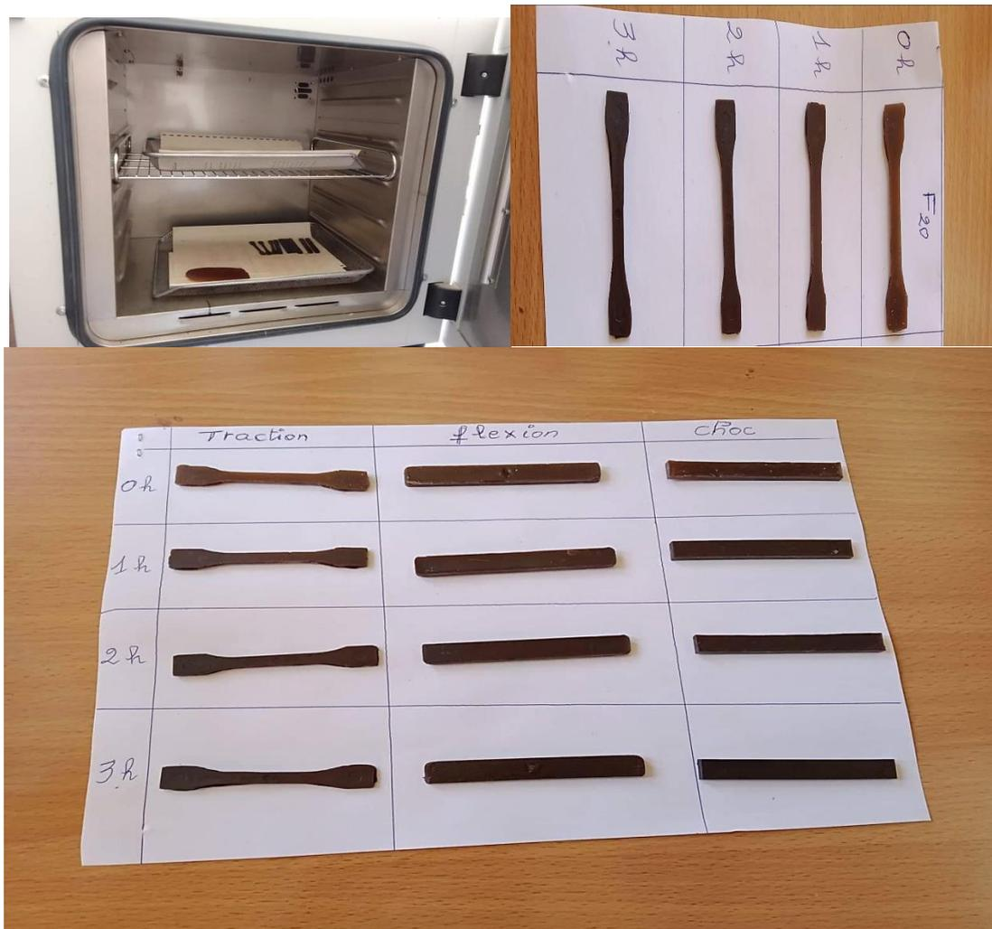
**Figure IV.1 :** Evolution de la couleur des éprouvettes de résine en fonction du traitement thermique.
