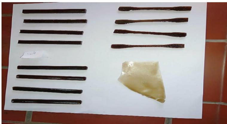
**Figure III. 8 :** Des éprouvettes de résine et films vieilli à 180 °C pendant 1h, 2h et 3h.
