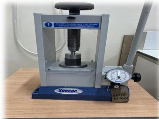
Figure II.19 : système moule +presse pour former une pastille
