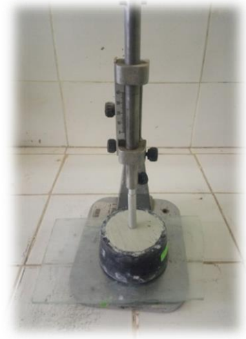
Figure II.12 : mesure de la consistance normalisée par l'appareil Vicat Après plusieurs mesures de d sur les pâtes zéolite+eau, on a opté pour un rapport E/Z=1 qui répond à l'exigence de la norme EN196-3.
