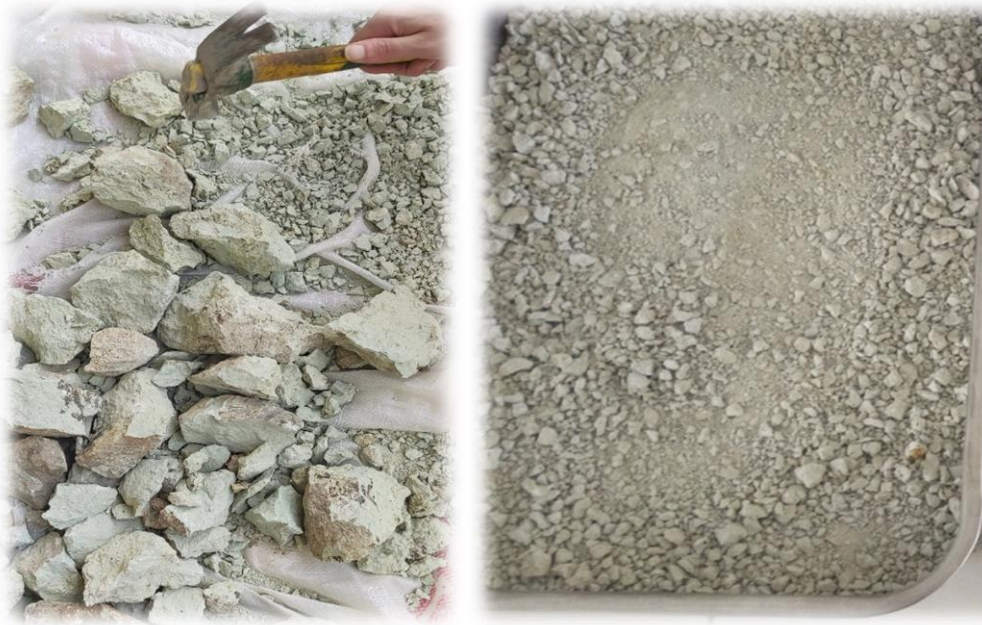
Figure II.4 : Concassage manuel des roches de zéolite
