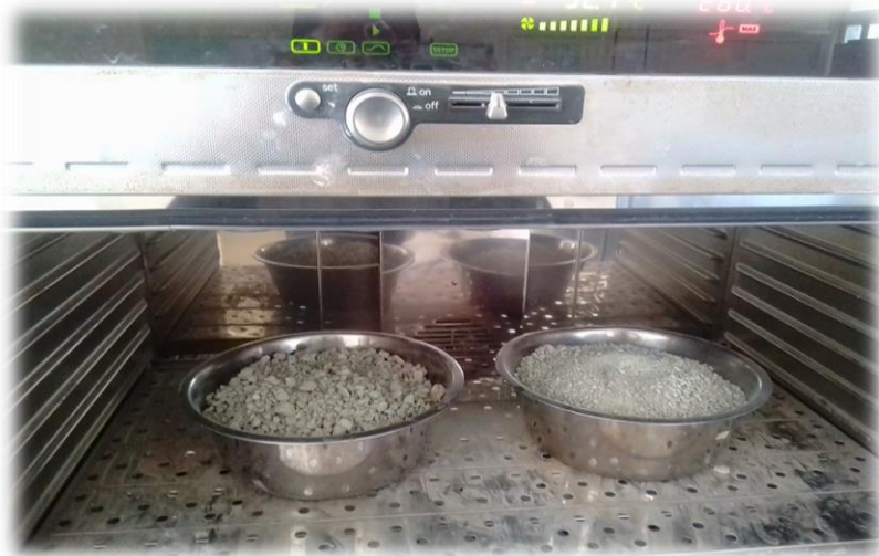
Figure II.5 : Etuvage du matériau utilisé
