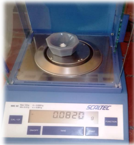
Figure II.18 : KBr + poudre à tester pesés sur une balance de précision 0.0001 gr
