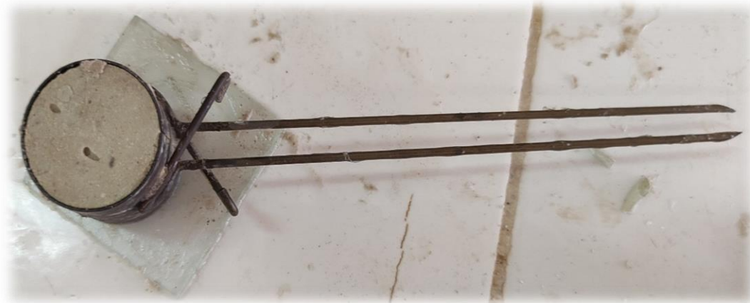
Figure II.14 : moule utilisé pour mesurer le gonflement.
