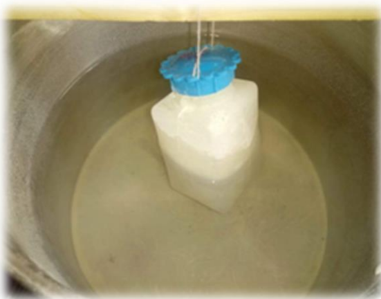
Figure II.15: bouteille en polyéthylène contenant l'échantillon dans un bain marie.
