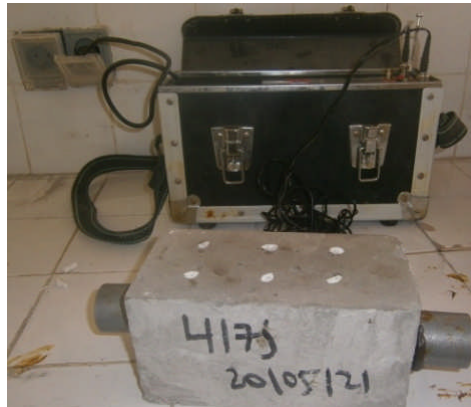
Figure III.6. Dispositif d'ultrason pour mesurer la vitesse de propagation de l'onde
