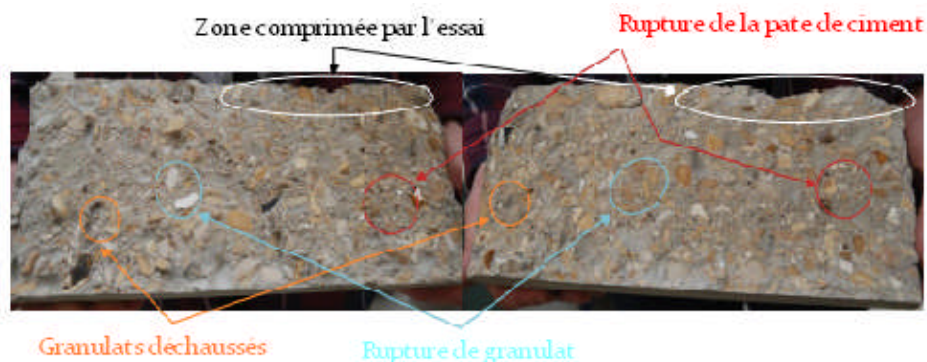
Figure III.4. Faciès des ruptures lors de l'essai de fendage (Jourdain, (2018))
