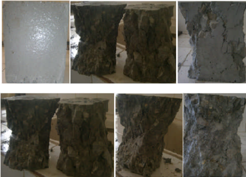
Figure VI.15. Exemples du mode de rupture du cube
