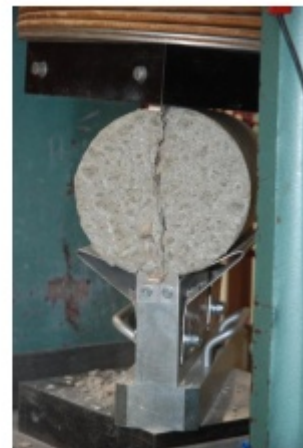
Figure III.3. Machine d'essai de fendage et positionnement de l'éprouvette à gauche et l'essai de fendage et éprouvette fendue à droite
