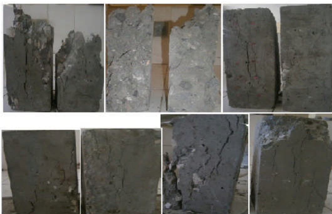
Figure VI.18. Exemples du mode de rupture du prisme
