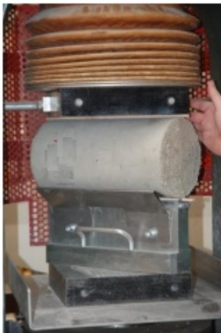
Figure III.3. Machine d'essai de fendage et positionnement de l'éprouvette à gauche et l'essai de fendage et éprouvette fendue à droite
