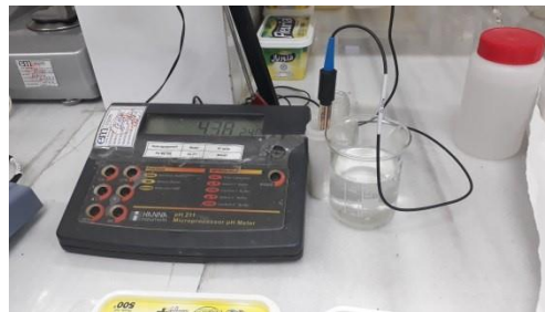
Figure02 : mesure de pH de l'eau osmosée à l'aide d'un pH mètre
