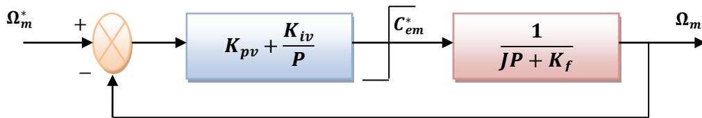
Figure III. 8 : Schéma de la boucle de régulation de vitesse
