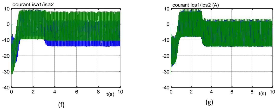
Figure II. 11 : Performance de la MASDE alimentée par deux onduleurs de tension en charge
