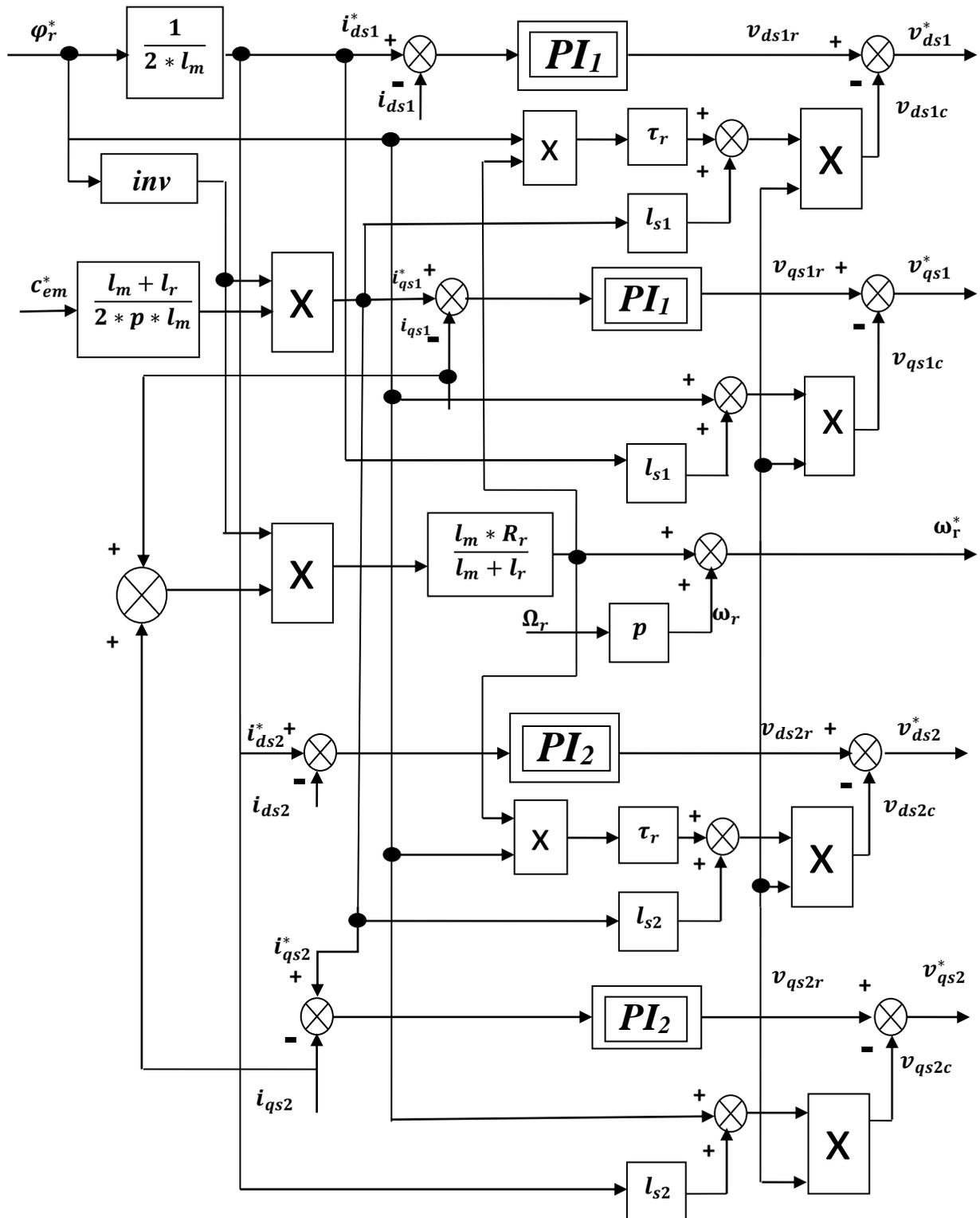
Figure III. 5 : Représentation schématique du bloc de découplage FOC
