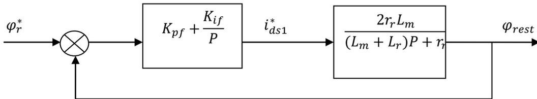
Figure III. 12 : Boucle de régulation de flux
