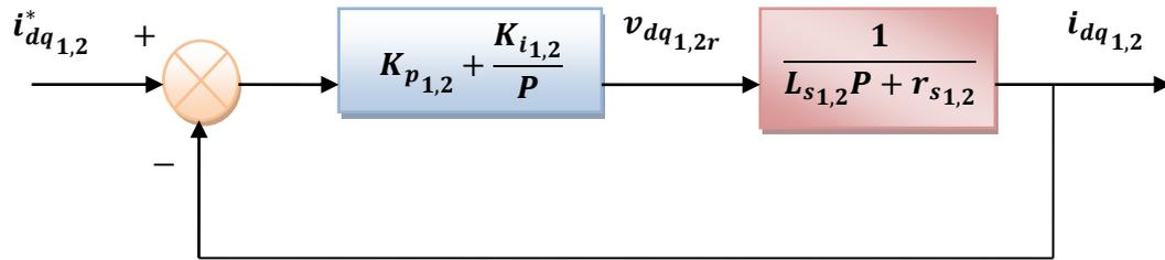
Figure III. 3 : Schéma de la boucle de régulation des courants statorique
