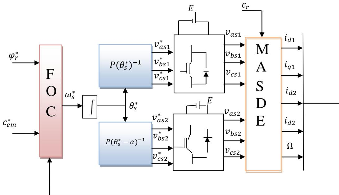
Figure III. 4 : Représentations schématique de la commande FOC sur la MASDE
