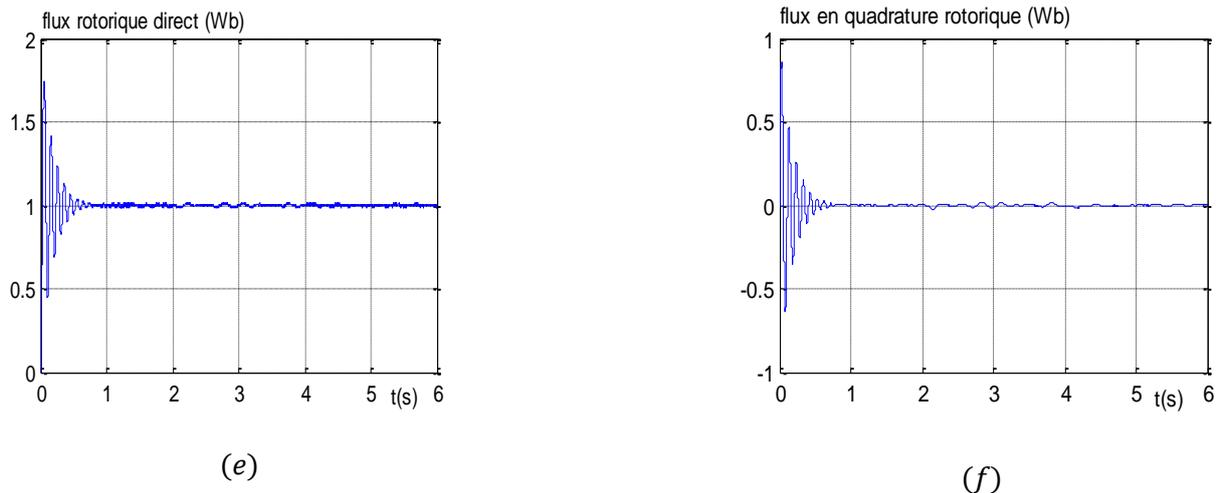
Figure III. 10 : L'évolution des caractéristiques de la MASDE par la commande vectorielle indirecte sans réglage de vitesse
