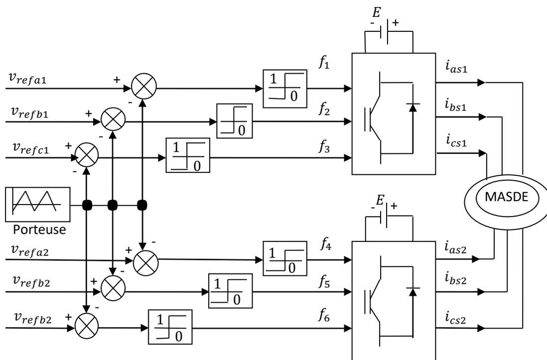
Figure II. 7 : Association MASDE-sources sinusoïdales
