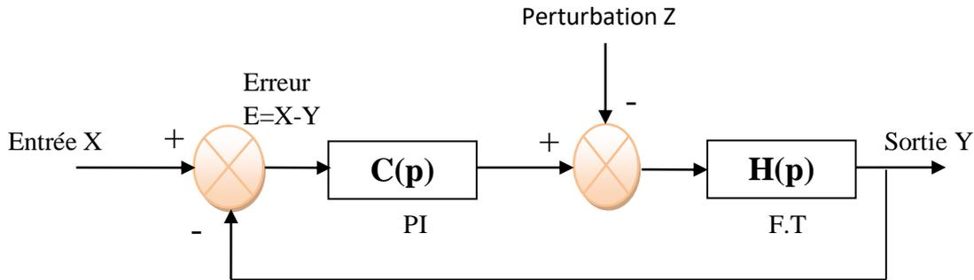
Figure III. 2 : Schéma d'un système asservi de premier ordre régulé par un PI
