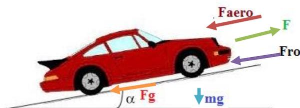
Figure IV. 1 : Représentation des forces agissant sur le véhicule électrique de masse ( $m$ ) se déplaçant sur une pente
