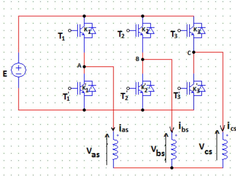
Figure II. 6 : schéma onduleur de tension triphasée
