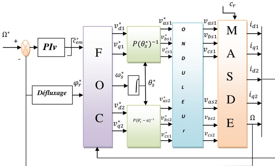
Figure III. 9 : Représentation schématique de la commande FOC avec régulation de vitesse
