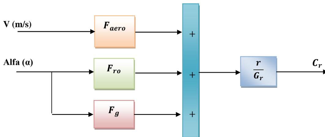
Figure IV. 2 : Schéma de la dynamique d'un couple résistant d'un véhicule électrique
