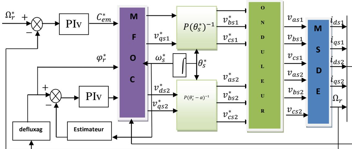
Figure III. 11 : Représentation de la commande MFOC sur la MASDE
