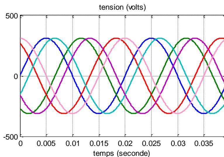
Figure II. 4 : Source de tensions triphasées décalées de 30°
