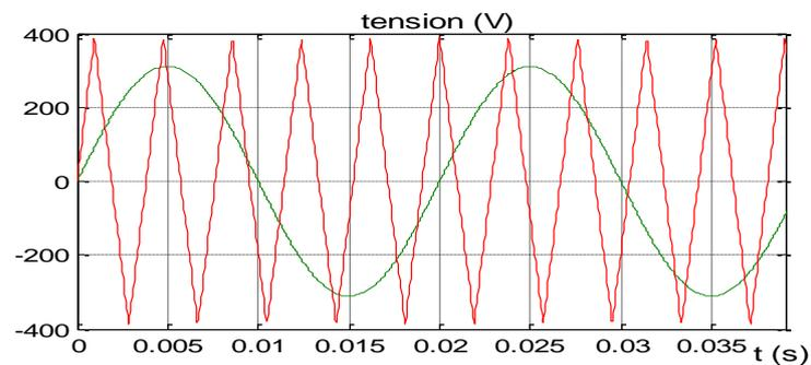
Figure II. 10 : Intersection tensions de référence et la porteuse
