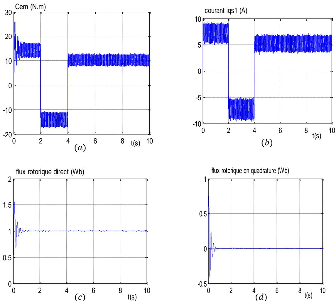
Figure III. 6 : L'évolution des caractéristiques de la MASDE par la commande vectorielle indirecte sans réglage de vitesse
