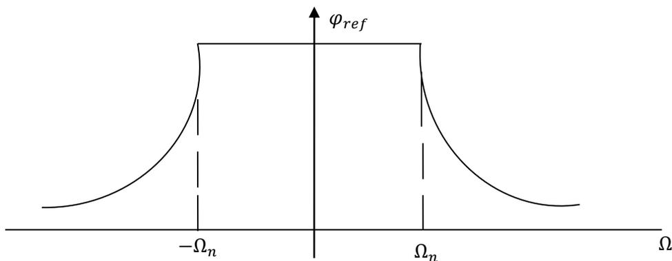
Figure III. 7 : Schéma de dé-fluxage
