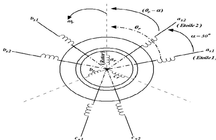
Figure II. 1 : Représentation schématique des enroulements de la MASDE
