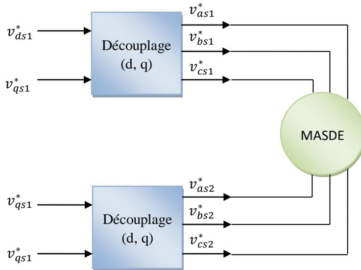
Figure III. 1 : Principe de pilotage vectoriel de la MASDE
