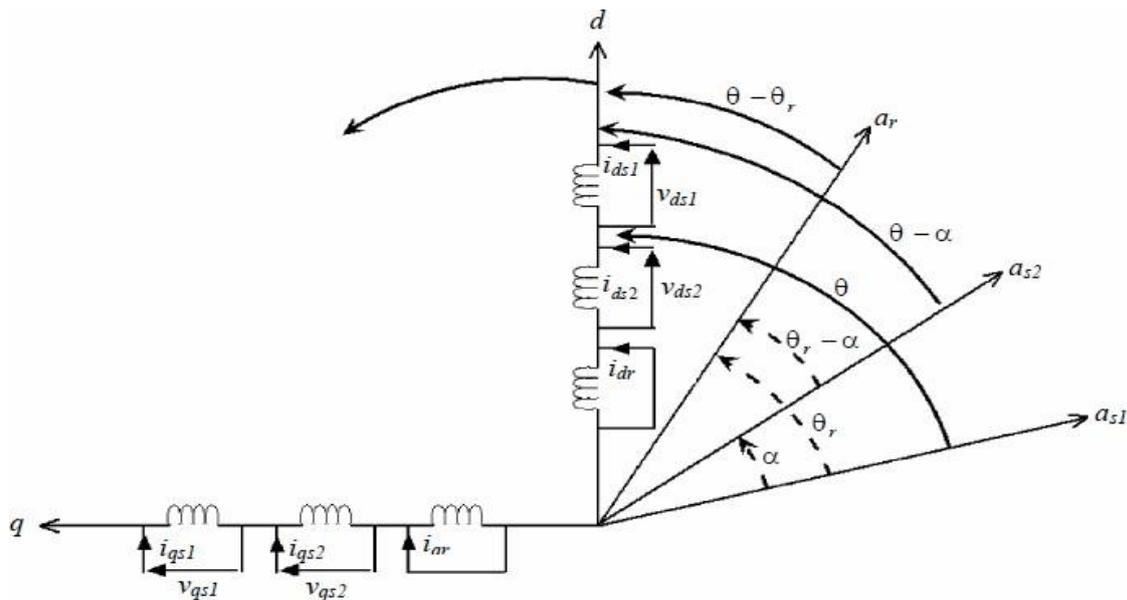
Figure II. 2 : Représentation du modèle généralisé de la MASDE sur l'axe « u,v »
