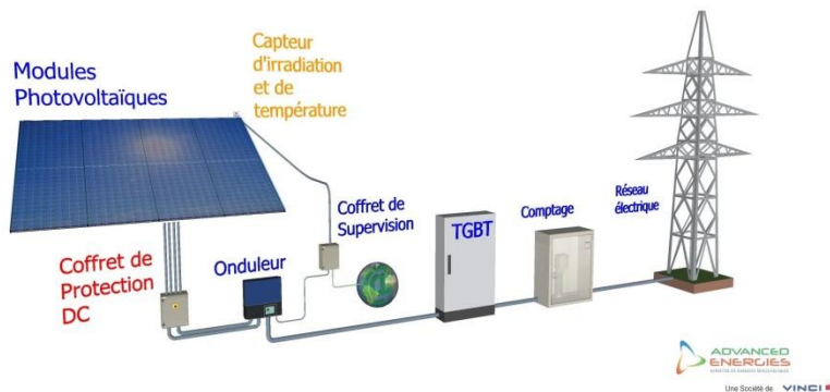
Figure I.4: Système d'alimentation photovoltaïque raccordé au réseau [6]
