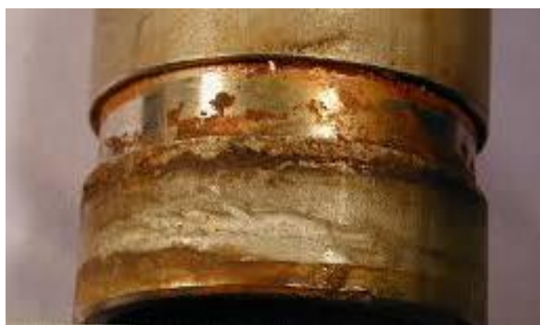
Figure I.5- Corrosion caverneuse d'un acier [3].
