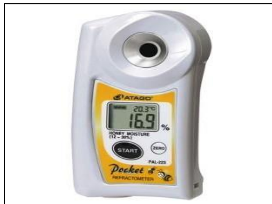
Figure 06. Refractomètre (ATAGO, ATAGO Co., Ltd, Japon) utilisé pour la détermination du °Brix.
