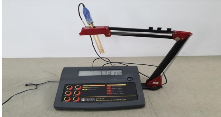
Figure 05. pH- mètre (Hanna® HI2210, Hanna Instruments) utilisé pour la mesure du pH.
