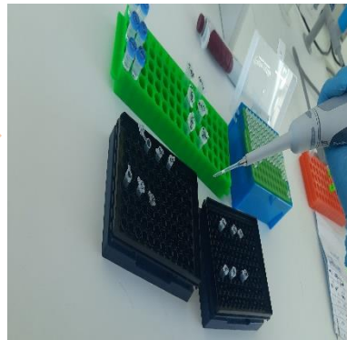
Transfère de 2 \mu l de la solution dans les tubes à PCR et 1 \mu l d'ADN extrait dans chaque tube avec 45 \mu l de la solution Mixer
