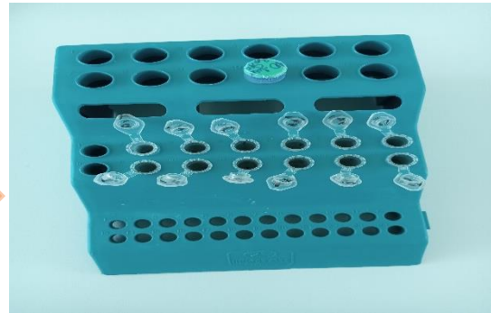
Ajout de 1 \mu l de bleu juice et 10 \mu l de solution dans des tubes à PCR.
