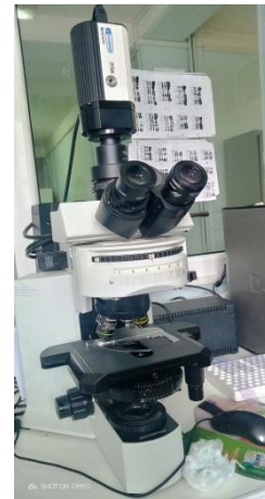
Microscope photonique équipé d'un appareil à photo numérique
