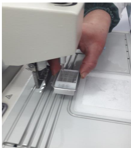
Figure 11: Cassette contenant échantillon de foie incluses dans de la paraffine
