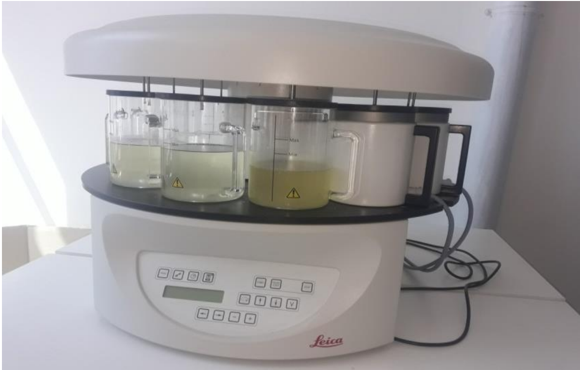
Figure 10 : Photographie montrant l'automate de déshydratation des échantillons.
