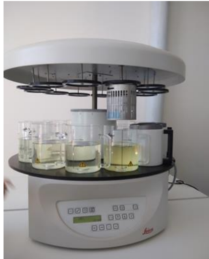
Figure 12 : Photographie originale de l'Automate de déshydratation.
