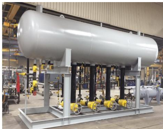
Figure I-11 La vue extérieure d'un ballon NH 3 .
