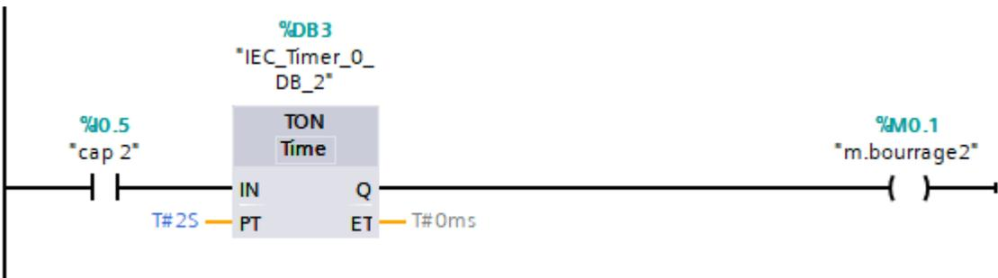
Figure D-2 : Schéma à contact du capteur de bourrage 2
