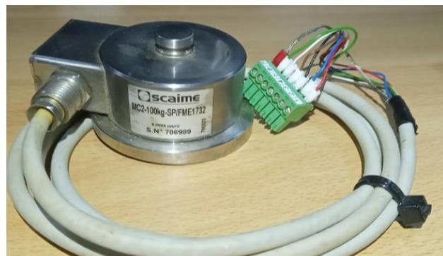
**Figure II-7 :** Illustration d'un capteur de pesage
