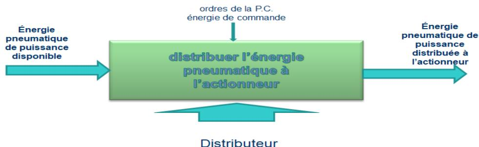
**Figure II-10** :Illustration d'un distributeur [12]
