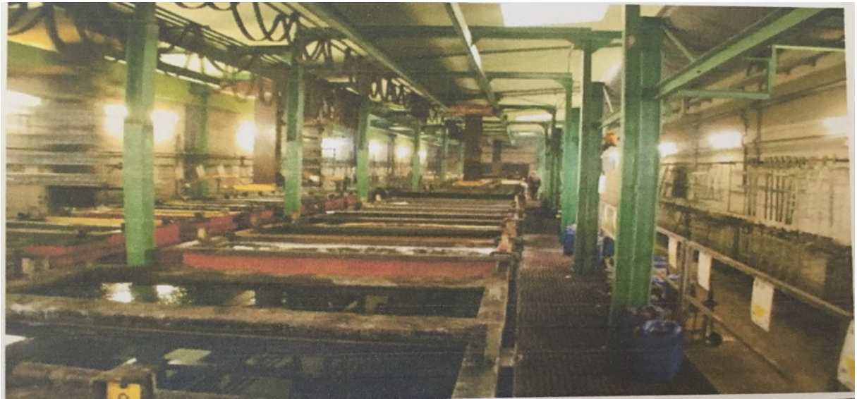
Figure I.2. Structure d'une chaîne d'atelier de traitement de surface.
