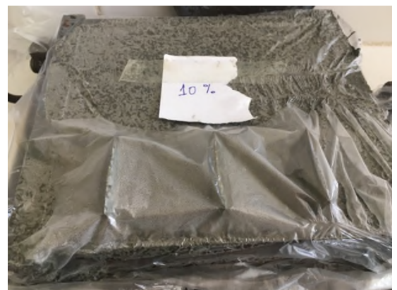
Figure II.23. Les échantillons moulés et enrobés de papier para-film
