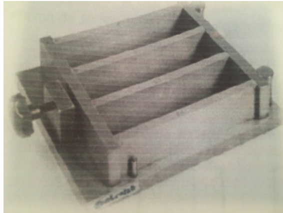
Figure II.22. Le moule utilisé pour la préparation des éprouvettes.
