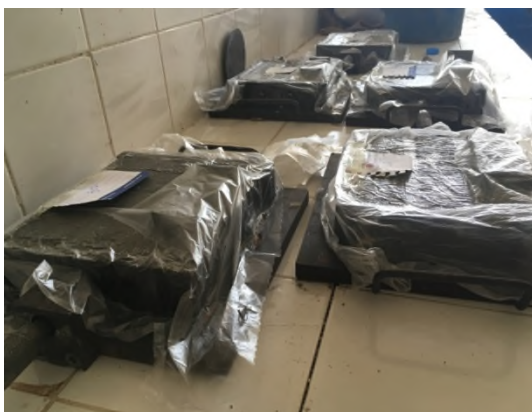
Figure II.23. Les échantillons moulés et enrobés de papier para-film
