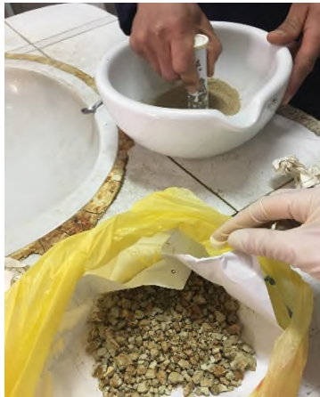
Figure II.14. Broyage de la boue avec un mortier.
