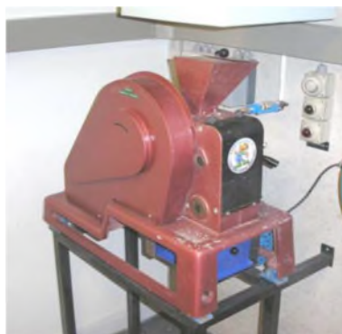
Figure II.8. Concasseur à mâchoires.
