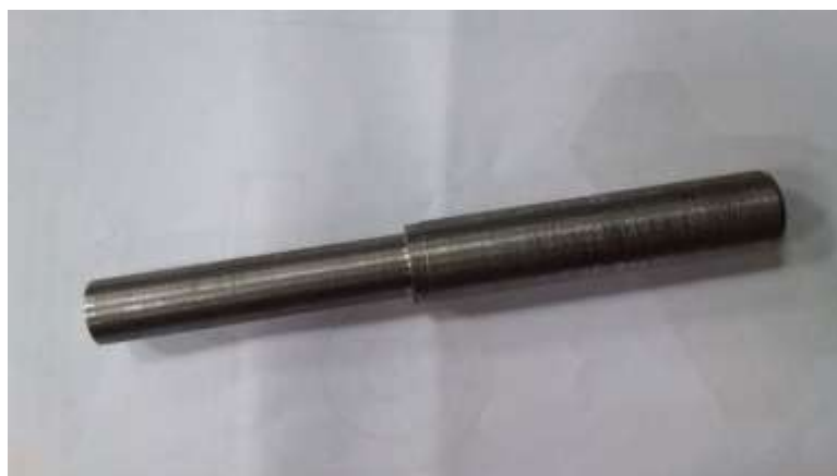
Figure III.5. L'arbre de rotation réalisé.
