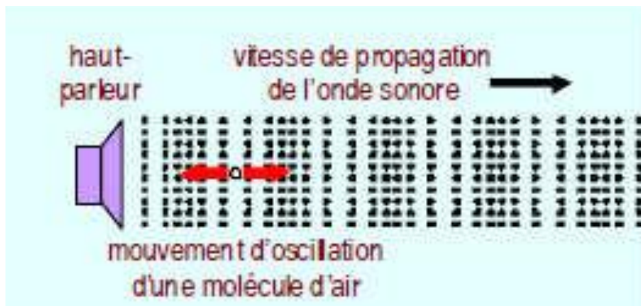
Fig. 1.6 Phénomène d'onde longitudinale dans les gaz.
