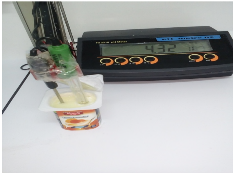
Figure 6 : Photographie de mesure du pH à l'aide de pH-mètre
