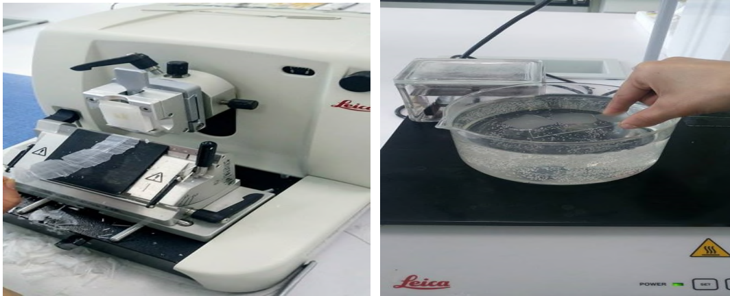
Figure N°15: Photographies du microtome et de la plaque chauffante.
