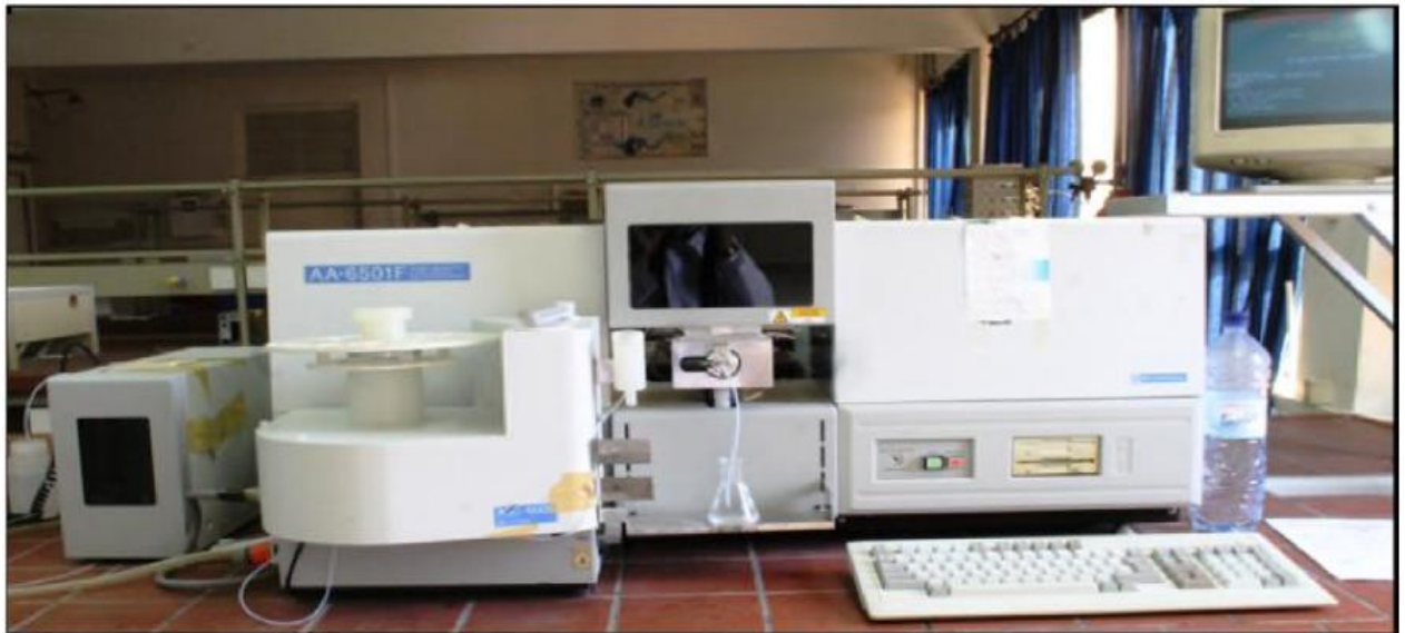
Figure 17- Le spectromètre d'absorption atomique en flamme AA6501F / Shimadzu du Laboratoire de Génie des procédés, Université de Bejaia.
