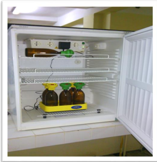
Figure (V, 9) : Incubateur de DBO5. jours d'incubation.
