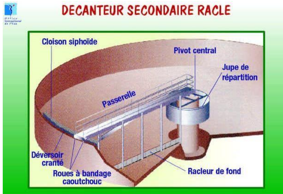
Figure (III,10) : Schéma de principe d'un décanteur secondaire (clarificateur).
