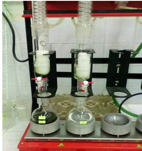
Figure 7 : Extraction par Soxhlet des alcaloïdes de Matricaria pubescens , Phoenix dactylifera et de leur mélange(original).
