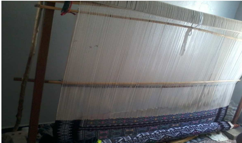
Photo N°2 : « azetta » le métier à tisser domestique (maison moderne) à Ait Hichem en 2016.
