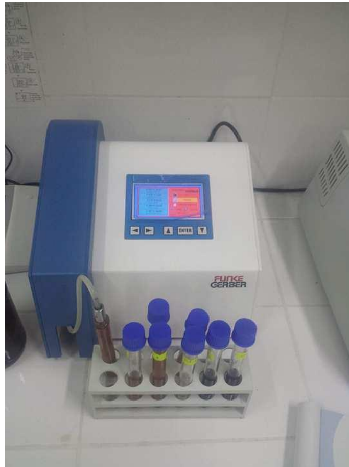
Figure n°1 : Dispositif du dosage d'éthanol assisté par l'appareil FUNK-GERBER.
