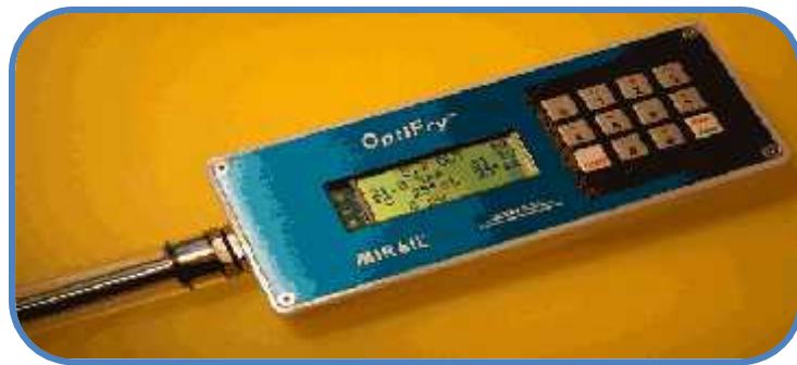
Figure12 : Photographie originale d'OPTIFRY MIROIL pour la mesure des composés polaires.
