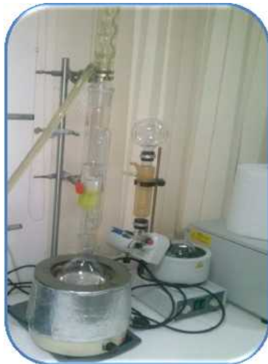
Figure 9 : Photographie d'extracteur Soxhlet et Evaporateur rotatif au niveau de laboratoire de recherche et développement Cevital.
