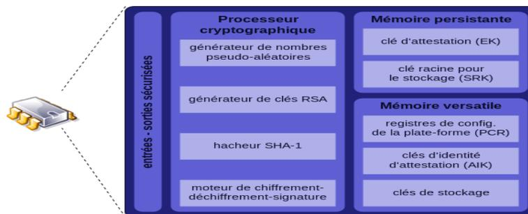
Figure 4.1 – Les composantes d'un module TPM[31].
