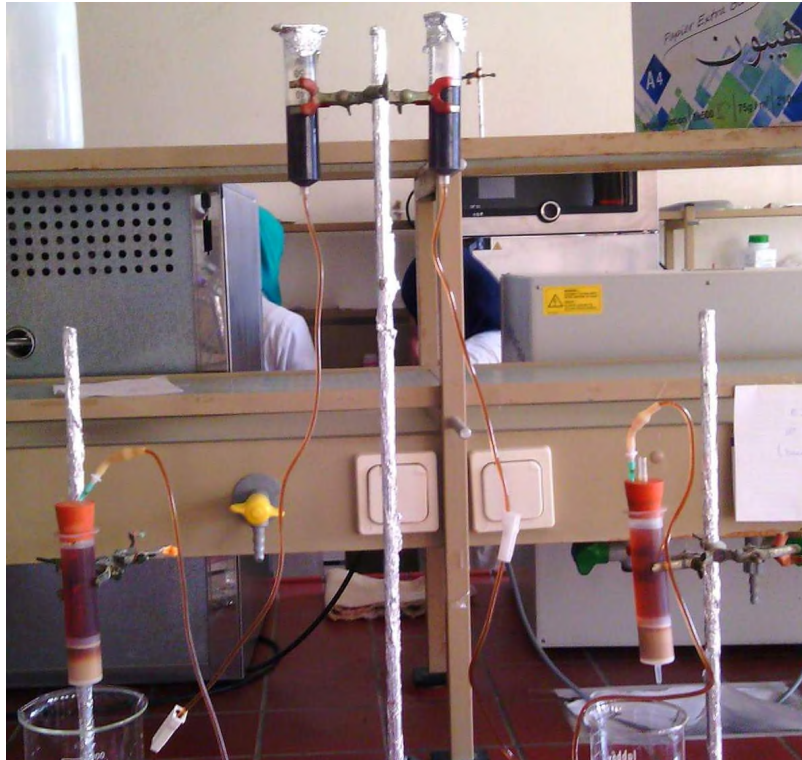
Figure 2 : Montage de la chromatographie effectuée sur gel C_{18} de type Discovery DSC-18.
