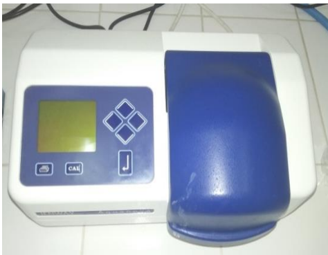
Spectrophotomètre de marque JENWAY Aquanova (mesure des nitrates, nitrites et ammonium).
