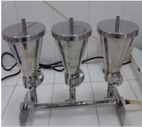
Système de filtration de marque Combisart Sartorius Stedim (analyse microbiologiques).
