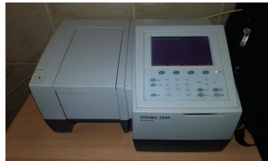
Spectrophotomètre UV-mini -1240 de marque SHIMADZU (mesure du fer, sulfates et phosphates)
