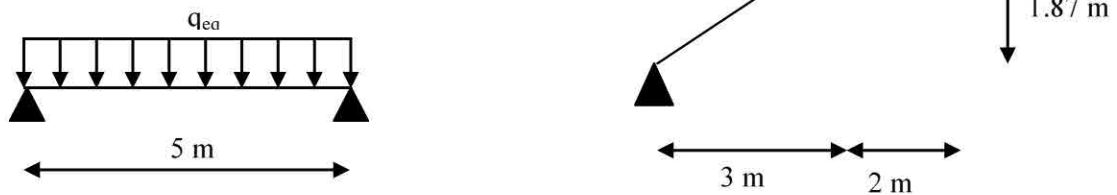
FigIII.18 Schéma statique de l'escalier T4
