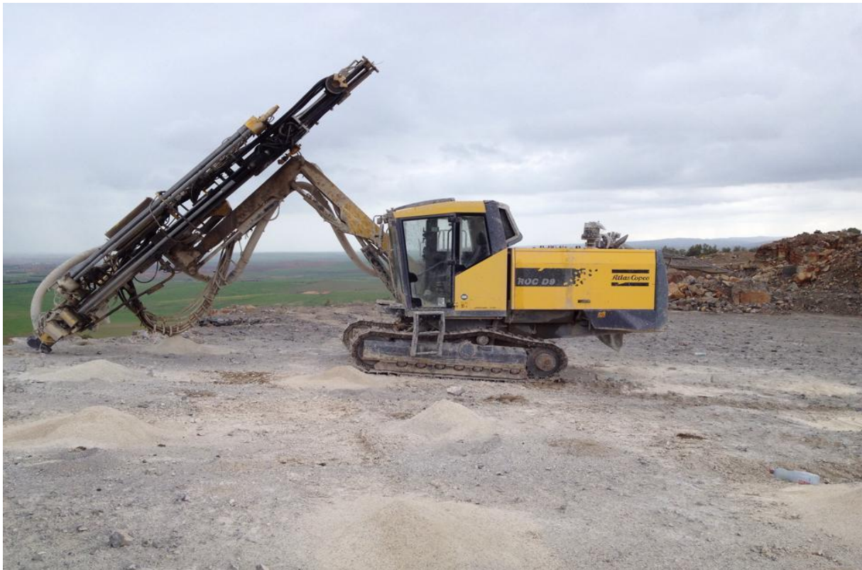
Figure II.4 : Chariot de foration (photo prise durant la période de notre stage).
