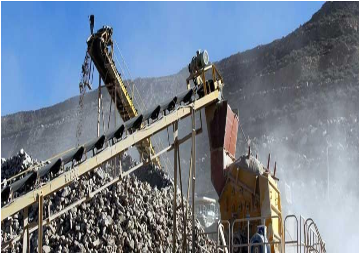
Figure II.10 : Station de concassage (photo prise durant notre période de stage au sien de l'unité UMABT)
