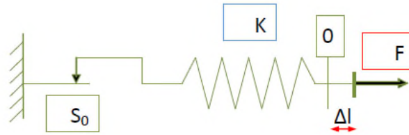
Figure III.2 : Modèle monodimensionnel du comportement élasto-plastique [16]
