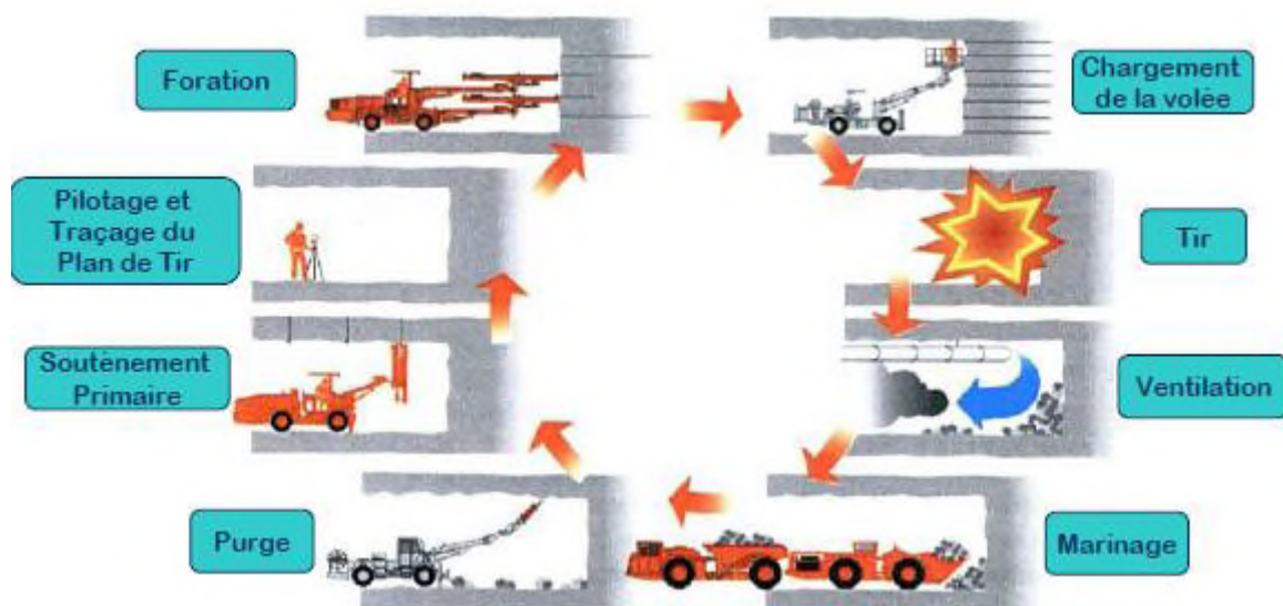
Figure I.2 : Illustration du cycle classique de creusement à l'explosif [3]
