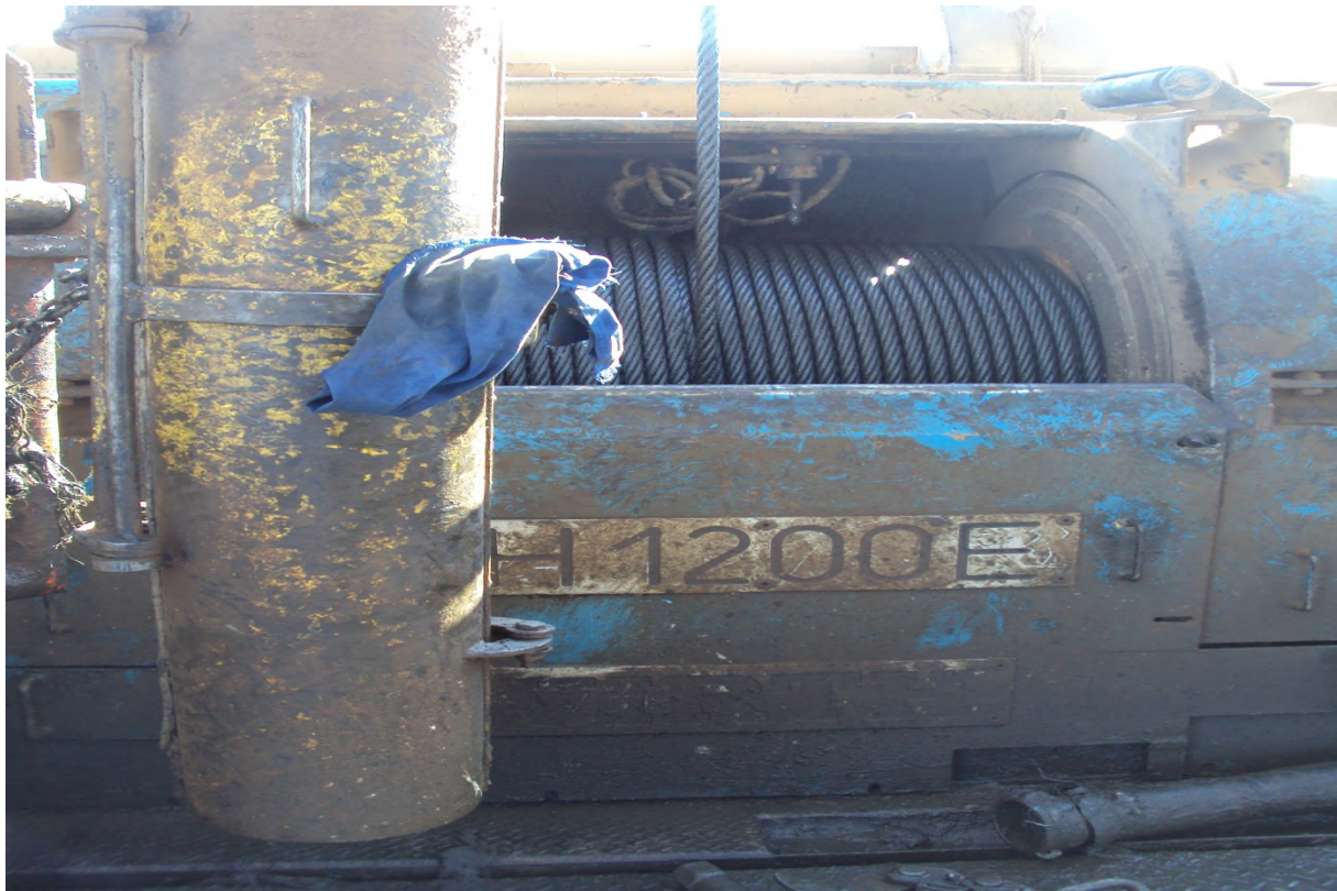
Figure II 17 : treuil de forage TP 201.(12/03/2015).
