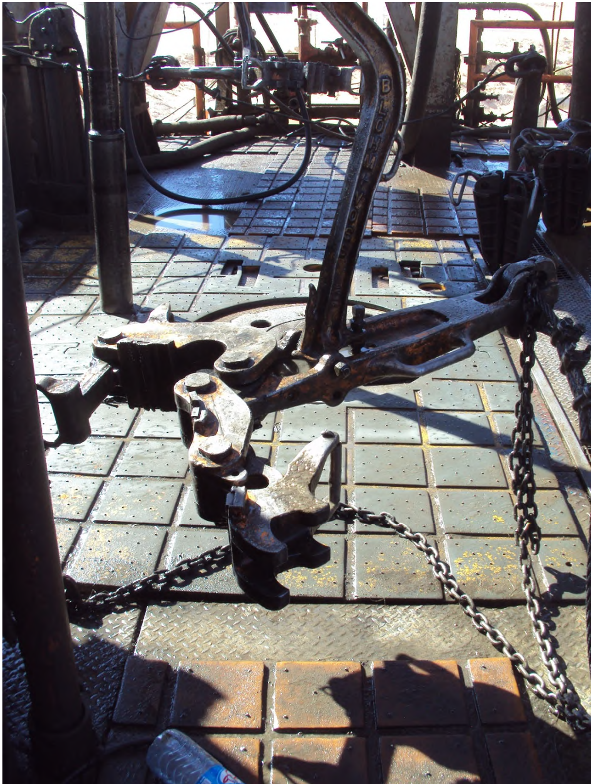
Figure II 22 : Clé manuelle de serrage des connexions,TP201.(12/03/2015).
