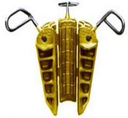
figure II 19 : coins pour les masses tiges.
