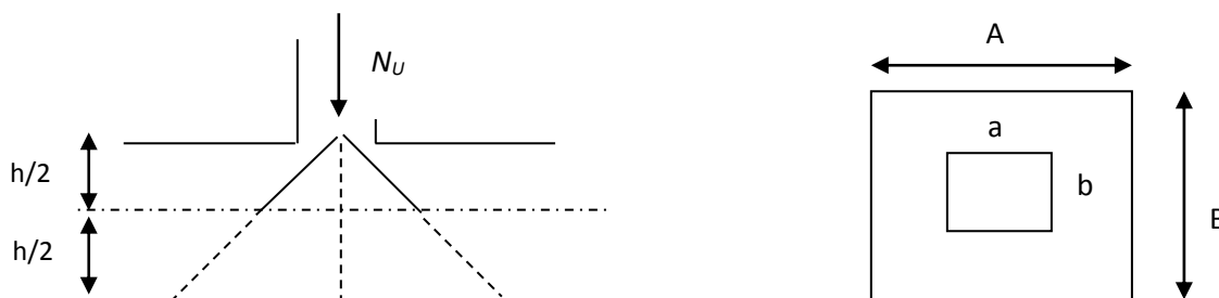
Figure. VI.3: Le travail de l'effort normal sur le poteau
