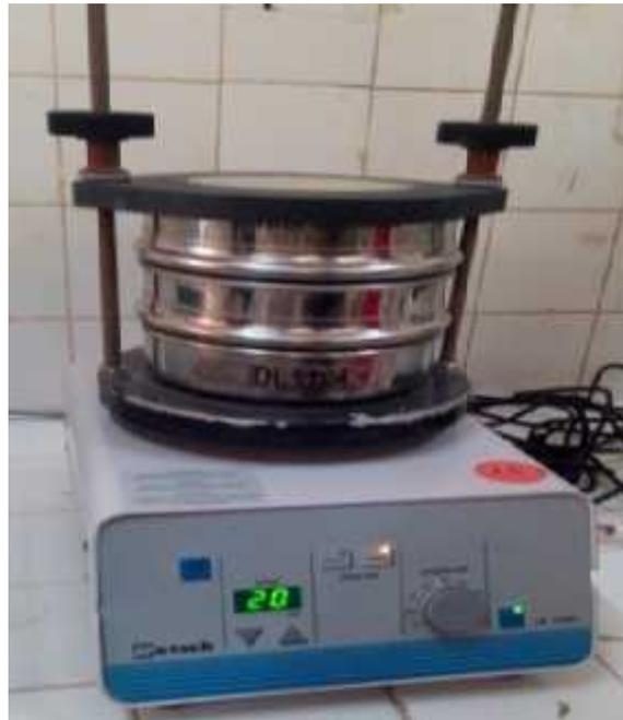
**Figure 17:** Tamiseuse électrique
