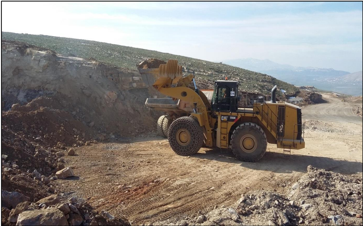
Figure VI.02: Chargeuse pneumatique Caterpillar 990 K.
