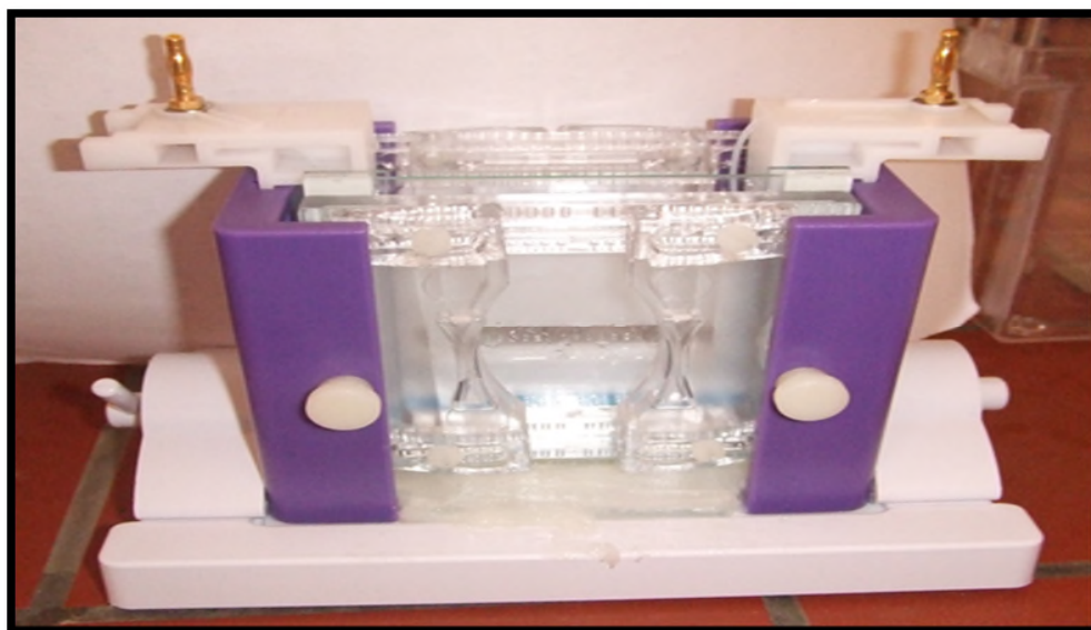
Figure 17 : Photographie montrant le montage des plaques d'une électrophorèse monodimensionnelle.
