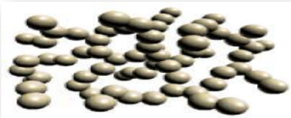
Figure. II.14: Structure d'un aérogel [33]
