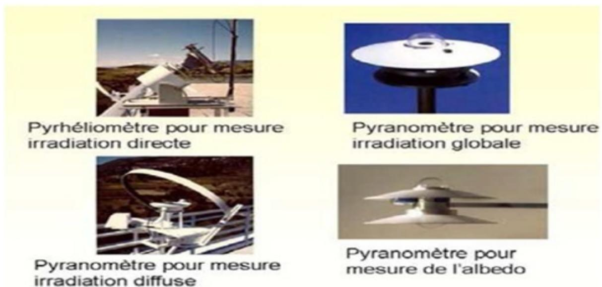
Figure II.3 : Appareils de mesures. [2]
