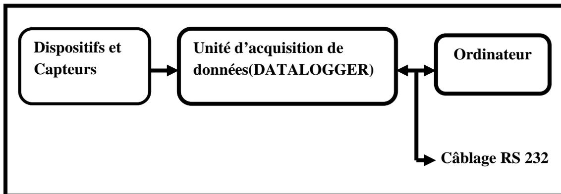
**Figure II.1 :** Schéma de la chaine de mesure.
