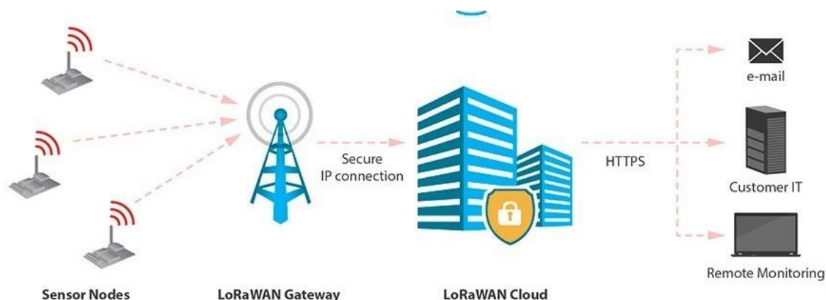
Figure 2.13 Architecture d'un réseau LPWAN
