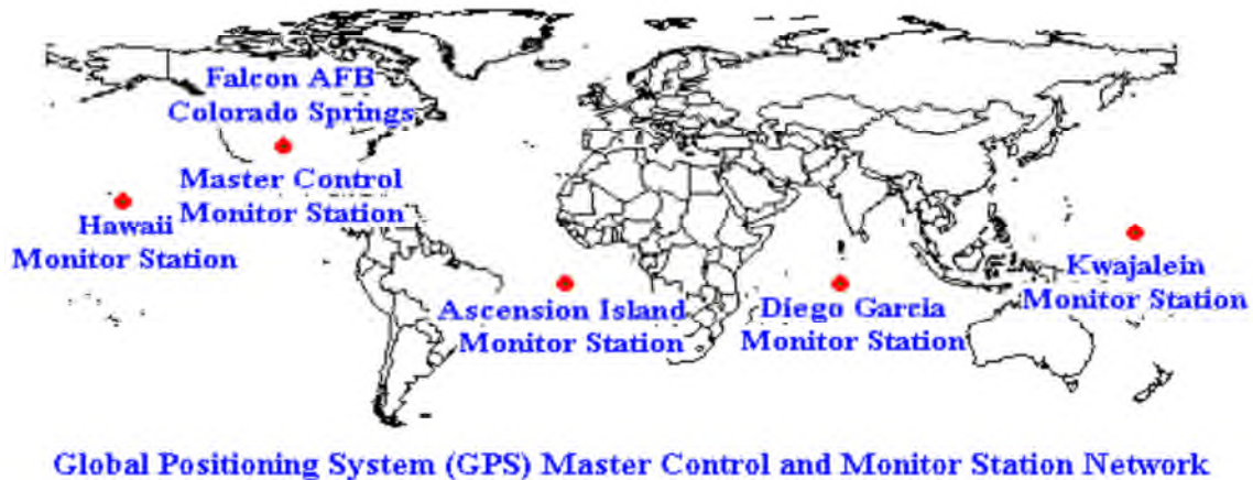
Figure 2.12 : Le segment de contrôle.
