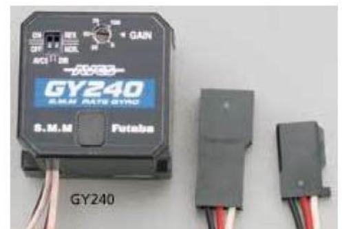
**Figure 1.12.** Gyromètre Futaba à structure vibrante
