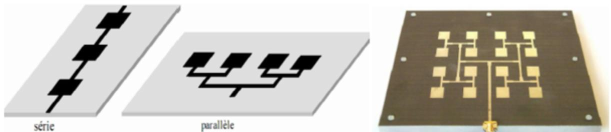
FIG. 2.9: Réalisations de réseau à alimentation (a) linéaire en série, (b) linéaire en parallèle et (c) bidimensionnel en parallèle [16]
