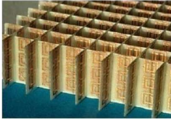
Figure 2.9: Structure main gauche bidimensionnelle.
