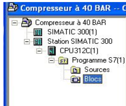
Figure III.3. : Hiérarchie du programme STEP7.
