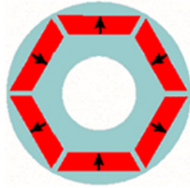
Figure I.10 : Rotor d'une machine synchrone à aimant permanent enterrés
