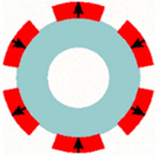
FigureI.8 : Rotor d'une machine synchrone disposé en surface
